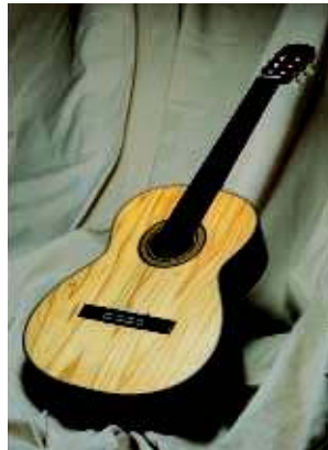
写真2 スギ小径丸太から製造したフェノール樹脂処理ギター。直径20センチほどのスギから得たベニヤ板に音質向上のための樹脂をしみ込ませ、2枚重ねた。裏板にもスギベニヤを使用。
