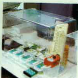
宇宙空間での植物栽培へ向けて実験が進む。毛細管現象を利用した給水方法なので重力は必要ない
