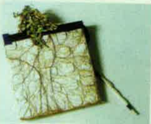
植物の根はセラミックスに吸いづくように伸びる。根が浸透圧によってちょうど吸水しやすいセラミックスを開発したところがミソ
